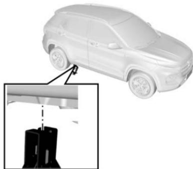
2. Como se muestra en la figura, las bridas en la parte inferior del lado del vehículo tienen marcas triangulares en los lados delantero y trasero, que representan la posición del punto de elevación.
