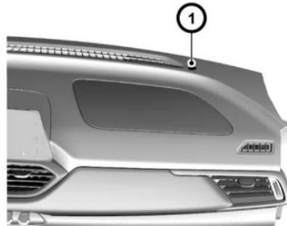
El A/C automático de temperatura constante está equipado con un sensor de temperatura de la luz solar ubicado en el lado derecho del tablero de instrumentos cerca del parabrisas delantero.
