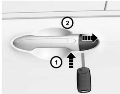
El orificio de la cerradura en la manija externa de la puerta delantera izquierda está oculto debajo de la cubierta de la moldura. La cubierta de la moldura debe retirarse primero si se usa la llave para abrir la puerta; por ejemplo, el control remoto se pierde o no tiene energía.
