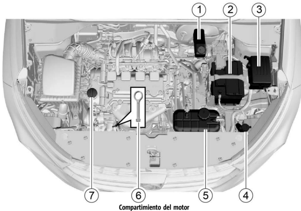
1. Líquido de frenos/Depósito de líquido de embrague
