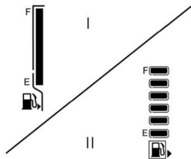
Muestra el nivel de combustible en el tanque de combustible.
