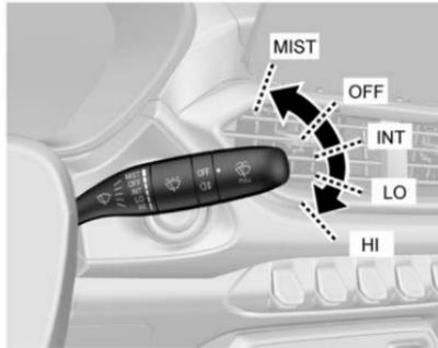
Para usar el limpiaparabrisas delantero, encienda primero la ignición y después empuje hacia abajo la palanca del limpiaparabrisas/lavaparabrisas. El limpiaparabrisas delantero tiene las siguientes cinco posiciones de operación:
