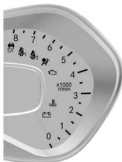
Muestra las revoluciones del cigüeñal del motor por minuto.
