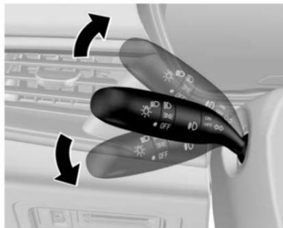
Palanca de control hacia arriba = luz direccional derecha
