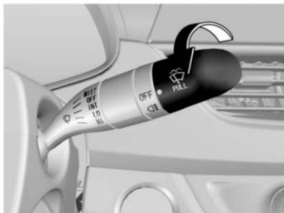
Cuando el faro está en luz baja o la luz antiniebla delantera está encendida, gire la perilla de control de la luz antiniebla trasera a la posición
