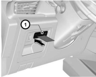
En el lado izquierdo del tablero de instrumentos, hay una ranura de tarjeta para colocar tarjetas.
