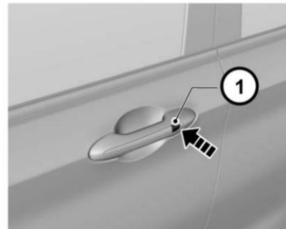
Cuando las puertas se desbloquean, la ignición está en la posición LOCK (bloqueo), y el transmisor RKE está dentro de 1.2 m de la manija de la puerta delantera, presionar el botón de bloqueo/desbloqueo en la manija de la puerta delantera desbloqueará todas las puertas.
