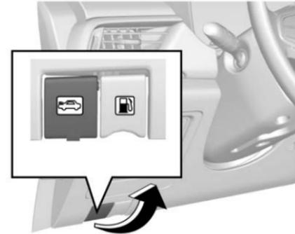
1. Jale la manija de liberación del cofre del motor en el lado inferior izquierdo del tablero de instrumentos y el cofre del motor se abrirá ligeramente.
