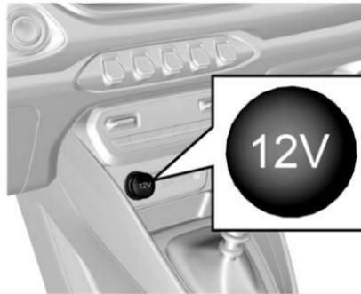
El tomacorriente de 12V está ubicado al frente de la consola, debajo del tablero de control de A/C. El tomacorriente no está disponible si la ignición está apagada.
