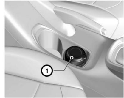
Está ubicado en la consola en medio de los asientos delanteros, los contenedores del cenicero se pueden mover dentro del vehículo. Abra su cubierta para usarlo.
