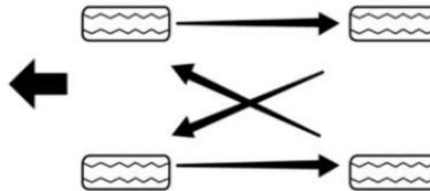
Las llantas delanteras y las llantas traseras tienen diferentes funciones y, por lo tanto, tienen diferentes niveles de desgaste.
