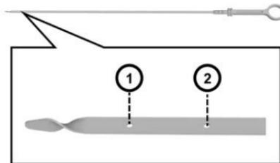
6. Revise el aceite del motor en la varilla de medición para asegurarse que el aceite no esté contaminado.
