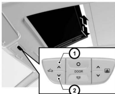
La parte delantera del vidrio del quemacocos se puede inclinar.
