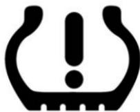
La luz de advertencia se ilumina después que se enciende la ignición y se apaga varios segundos después. Esto indica que la luz de advertencia puede funcionar normalmente.
