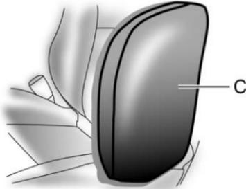
Como se muestra en la Figura C, la bolsa de aire lateral del asiento delantero está instalada en el lado del respaldo cerca de la puerta.
