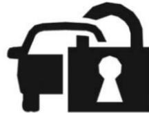
Este indicador se ilumina cuando se abre la puerta. Se apaga después que arranca el motor. Esto indica que el indicador puede funcionar normalmente.
