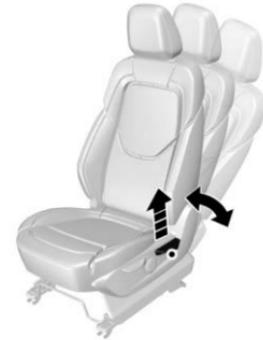
Jale hacia arriba la palanca y ajuste el ángulo de inclinación del respaldo a una posición adecuada y después suelte la palanca. No se apoye en el respaldo del asiento mientras lo ajusta. Después de ajustar el respaldo, apóyese sobre él para asegurarse que esté bloqueado en su lugar.
