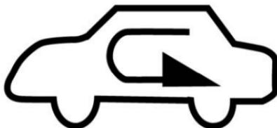
Cuando se enciende la ignición, presione este botón para cambiar entre los modos de circulación de aire interior y exterior. Cuando se usa el modo de circulación interna, el indicador debajo del botón de circulación interna se ilumina.
