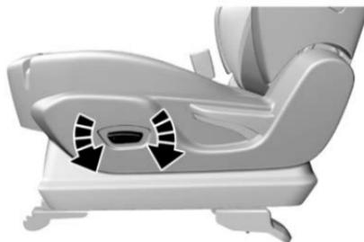
Gire el interruptor de ajuste de altura en el lado exterior del cojín del asiento, y después libere el interruptor después de ajustar el asiento a la altura requerida. Gire el interruptor en sentido contrario a las manecillas del reloj para bajar y en sentido de las manecillas del reloj para subir.
