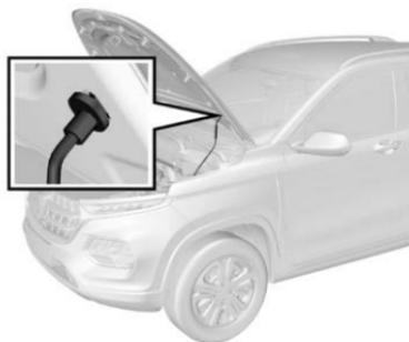
3. Separe la varilla de soporte del cofre del motor de la abrazadera de fijación. Levante la varilla de apoyo e inserte firmemente el extremo libre en la ranura del cofre del motor.
