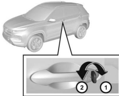
Al bloquear la puerta, inserte la llave y gírela en el sentido de las manecillas del reloj. Gire la llave en sentido contrario a las manecillas del reloj para desbloquear la puerta.
