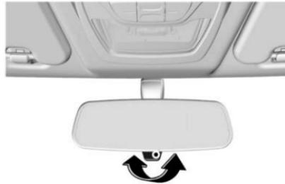
Los espejos retrovisores interiores se pueden ajustar manualmente a un ángulo de visión apropiado.
