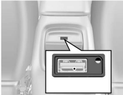
Si el vehículo está equipado con tomacorriente USB para accesorios trasero (5V), está ubicado en la parte trasera de la consola. Se puede usar para cargar teléfonos celulares, con una corriente de carga máxima de 1A. El tomacorriente está disponible si la ignición está apagada.
