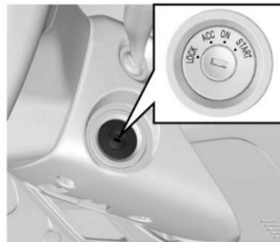
Cuando se gira la ignición en el lado derecho de la columna de dirección, las posiciones de operación son las siguientes:
