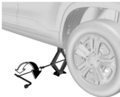
5. Gire el estribo del gato en sentido de las manecillas del reloj para permitir que el gato suba lentamente y asegúrese que la cabeza del gato esté firmemente presionada en la posición de elevación. No intente levantar el vehículo antes de colocar el gato en una posición adecuada. El gato debe estar firmemente sujeto entre el vehículo y el suelo.
