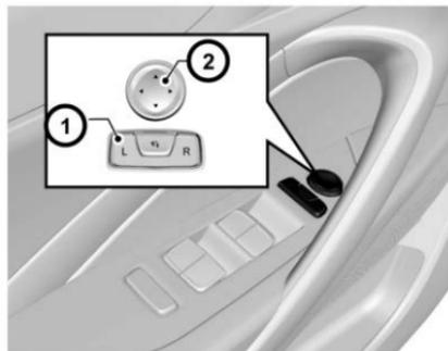
El interruptor de ajuste del espejo retrovisor está ubicado en el tablero del descansabrazos de la puerta en el lado del conductor para realizar ajustes hacia arriba, hacia abajo, hacia la izquierda y hacia la derecha.
