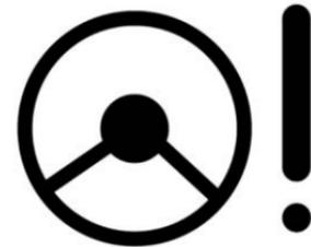
Esta luz de advertencia se encenderá inmediatamente cuando se encienda la ignición. Indica que el sistema está realizando una inspección automática y que el foco de la luz de advertencia puede funcionar normalmente. La luz de advertencia se apaga varios segundos después.
