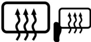
Para encender el desempañador, primero encienda la ignición y luego presione el botón del desempañador del parabrisas trasero. El indicador debajo del botón se ilumina. Presione nuevamente para apagar el desempañador y el indicador debajo del botón se apagará.
