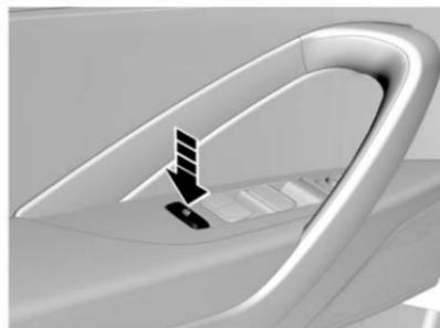
El botón de bloqueo de la ventana eléctrica se puede presionar para bloquear la ventana trasera y el interruptor de la ventana del lado del pasajero delantero. Cuando se presiona el botón, las ventanas traseras y la ventana del lado del pasajero delantero sólo se pueden controlar mediante el tablero de control de la ventana en el lado del conductor. Presione de nuevo para desbloquear.
