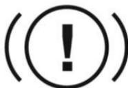
La luz de advertencia del sistema de frenos se enciende después de encender la ignición y se apaga varios segundos después (si se suelta el freno de estacionamiento). Esto indica que la luz de advertencia puede funcionar normalmente.
