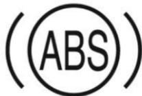
La luz de advertencia del ABS se encenderá inmediatamente cuando se encienda la ignición. Indica que el sistema está realizando una inspección automática y que el foco de la luz de advertencia puede funcionar normalmente. La luz de advertencia se apaga varios segundos después.
