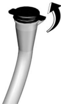
Antes de conducir, verifique el volumen de líquido de lavado en el depósito de líquido de lavado de parabrisas.
