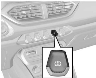
Para vehículos equipados con TPMS (sistema de monitoreo de presión de llantas) indirecto, debe restablecer el TPMS después de reemplazar la llanta o el ajuste de inflado de presión de la llanta, en pasos como:
