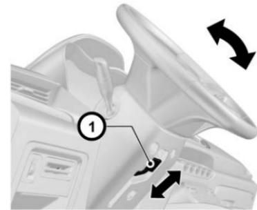
De acuerdo con la configuración, el ángulo del volante de algunos modelos de vehículos se puede ajustar hacia arriba y hacia abajo. Sólo se permite ajustar el volante después de que el vehículo se haya detenido por completo.
