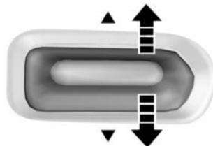
Con el interruptor de volumen de aire encendido, jale hacia arriba/hacia abajo para aumentar o disminuir la temperatura. La barra de pantalla de temperatura en la pantalla muestra la temperatura correspondiente. "H" representa caliente y "C" representa frío. Una vez que la temperatura alcanza el extremo más caliente o más frío, si vuelve a subir el interruptor, la temperatura se mantendrá sin cambios.
