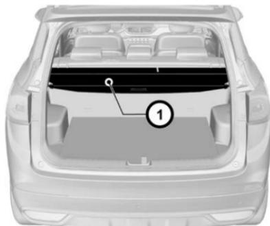
La cubierta se utiliza para proteger los objetos en el compartimiento de equipaje.
