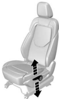
Al ajustar la posición del cojín del asiento del conductor, levante o baje la manija en el costado del cojín del asiento hasta que se ajuste a la posición deseada. Al ajustar la altura del asiento del conductor, el asiento debe estar cargado, de lo contrario, el dispositivo de ajuste puede dañarse.
