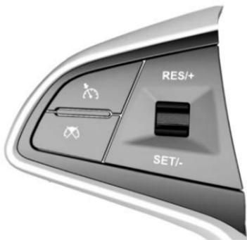
Los botones del control de velocidad constante están ubicados en el volante. Cuando se inicia el sistema de control de velocidad constante, el vehículo puede operar en la velocidad establecida. Presione el pedal del freno, y la función se
