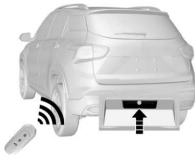
Cuando las puertas están bloqueadas, la ignición está en la posición LOCK y el transmisor RKE está a 1,2 m de la puerta trasera, al presionar el botón de liberación de la puerta trasera se desbloqueará la puerta trasera. La puerta trasera se abrirá
