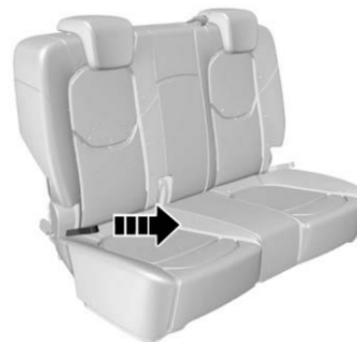
Hay correas de desbloqueo del respaldo en los lados izquierdo y derecho del asiento trasero 6/4, y jale la correa para desbloquear el respaldo correspondiente.
