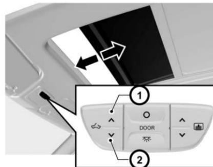
El quemacocos se puede abrir hacia atrás después de que esté completamente inclinado.
