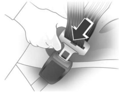
Saque el cinturón de seguridad del retractor, guíelo alrededor del cuerpo sin girarlo e inserte la lengüeta de bloqueo en la hebilla para asegurarlo. Al conducir, jale con fuerza del cinturón de hombro para ajustar la tensión del cinturón de cadera.
