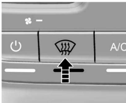
Presione el botón de descongelamiento delantero para activar el modo de descongelamiento del parabrisas delantero. El indicador debajo del botón se ilumina, la
