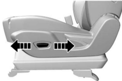
El interruptor de ajuste eléctrico está en el lado exterior del asiento. Presione el interruptor hacia adelante o hacia atrás, y el asiento se moverá hacia adelante o hacia atrás según corresponda. Libere el interruptor cuando alcance una posición adecuada.
