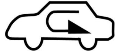
Cuando se enciende la ignición, presione este botón para cambiar entre los modos de circulación de aire interior y exterior. Cuando se usa el modo de circulación interna, el indicador debajo del botón de circulación interna se ilumina.
