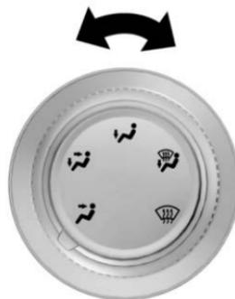
Ajuste la perilla de distribución de aire al modo deseado para que el aire fluya en la dirección deseada. La perilla de distribución de aire se puede configurar en una de las siguientes cinco posiciones:
