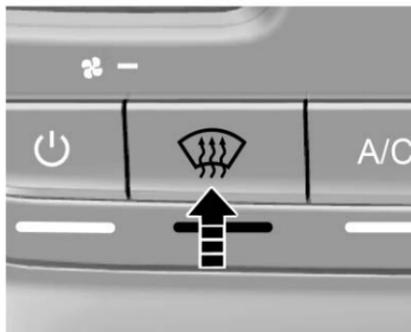
Presione el botón de descongelamiento delantero para activar el modo de descongelamiento del parabrisas delantero. El indicador debajo del botón se ilumina, la circulación de aire se ajusta automáticamente al circuito exterior, se
